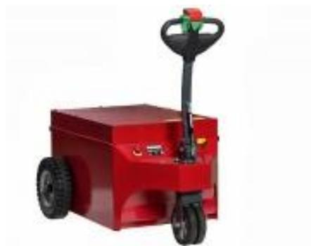
Multi-Mover XXL – электрические тягача способные буксировать не самоходные колесные грузы (прицеп, тележку, автомобиль) массой до 20000 кг на колесах и 35000 кг на рельсах.
